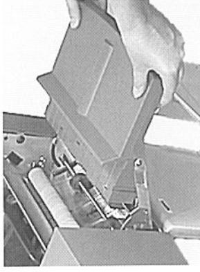
Der Einbau des Teils... Schließen Sie das Tablet in seine Positionsführungen und schieben Sie es, bis es in seiner Position einrastet.
