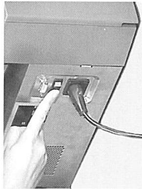
Stecken Sie das Netzkabel in die Steckvorrichtung auf der linken Seite der Maschine ein. Stecken Sie das Netzkabel in eine geeignete Steckdose ein. Bitte sorgen Sie dafür, daß sich die Steckdose in der Nähe der Maschine befindet und leicht zugänglich ist.
