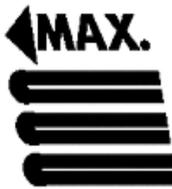
Maximale Magazinkapazität für Broschüren mit dickem Deckblatt (maximale Höhe: 250 mm).
