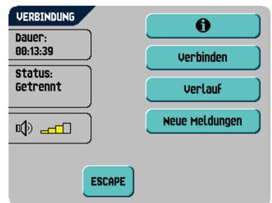
Sie können den Status der Verbindung auf dem Bildschirm anzeigen. Der Text auf der Schaltfläche wechselt zu **Trennen**.
