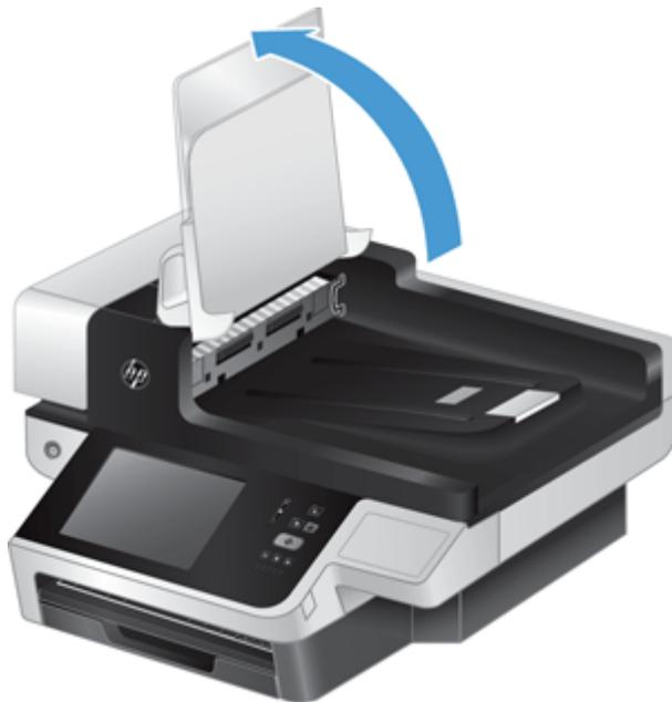
6. Drücken Sie auf die Duplexhintergrund-Arretierungen am ADF, um den ADF-Duplexhintergrund (1) freizugeben. Ziehen Sie diesen dann nach vorne, um ihn aus dem Gehäuse (2) zu entfernen.
