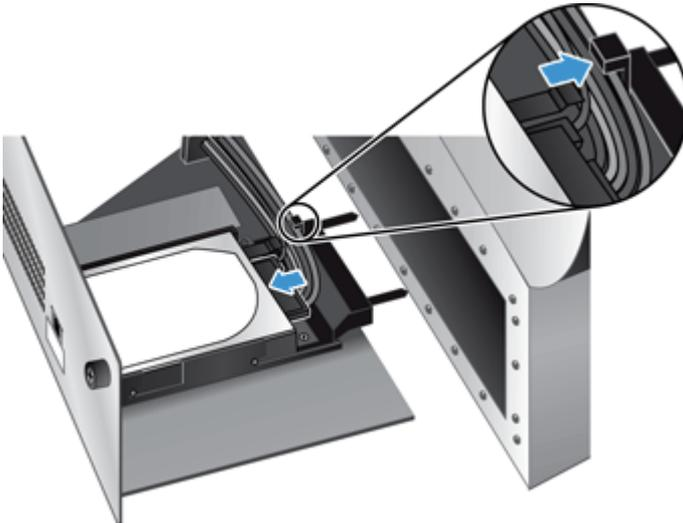
7. Schieben die Fachbaugruppe der Geräterückseite in das Gerät. Achten Sie darauf, dass keine Kabel eingeklemmt werden. Stellen Sie sicher, dass die Fachbaugruppe richtig am Gehäuse sitzt, und ziehen Sie die Schrauben fest.
