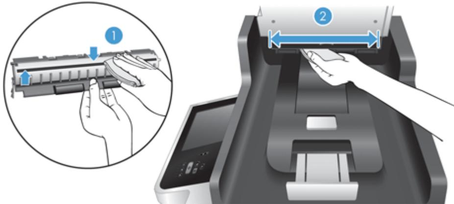
8. Trocknen Sie die Streifen mit einem trockenen, weichen und fusselfreien Tuch ab und schieben Sie die Komponente wieder in ihr Gehäuse, bis beide Arretierungen einrasten.
