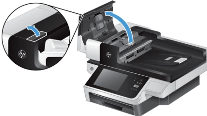
3. Greifen Sie mit der Fingerspitze vorsichtig hinter die Arretierung an der Klappe zur Walzenbaugruppe, und ziehen Sie diese vorsichtig nach vorne unten, um die Klappe zu öffnen.
