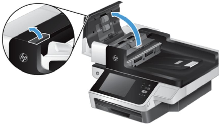
3. Klappen Sie das ADF-Zufuhrfach (1) hoch. Drücken Sie dann die Trennstegverriegelung nach vorne, um den Trennsteg aus seiner gesperrten Position freizugeben (2).
